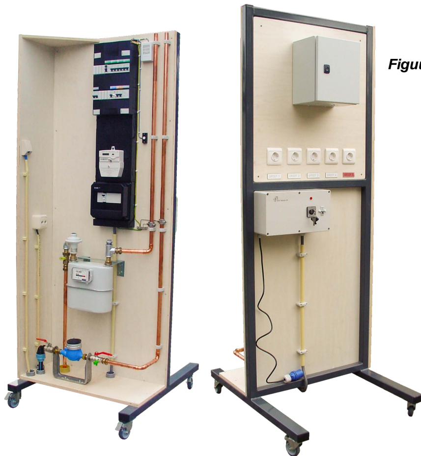
Figuur 14 Foutensimulator meterkast.
