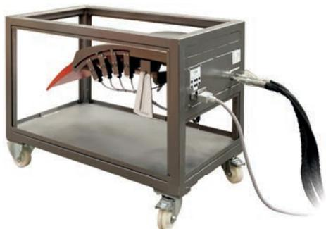
Cette partie opérative reproduit la cinématique d'un volet d'aéronef avec la possibilité d'une commande hydraulique "Tout ou Rien" ou en commande proportionnelle.
