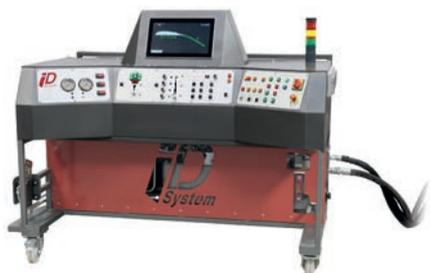
Le pupitre de commande, inspiré d'un Dashboard, permet le contrôle des parties opératives, la réalisation et la mise en oeuvre de circuits hydrauliques et électriques par câblage entre les composants (fournis sous forme de modules) et une centrale hydraulique.
